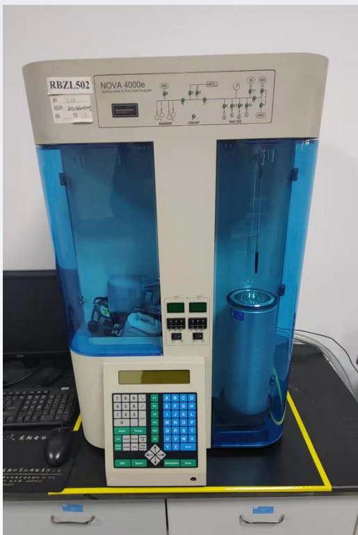
BET检测仪 (原材料比表面积 检测)
